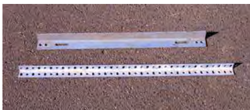
改修に使うL型鋼
